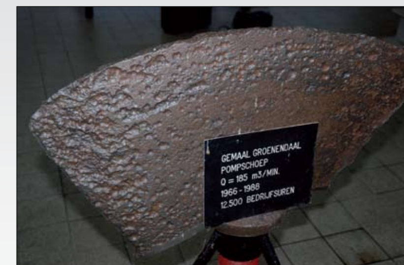
Een gladde pompschroef die onderhevig is aan cavitatie
